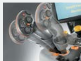
Принудительный режим движения позволяет оператору изменять направление и скорость движения машины
