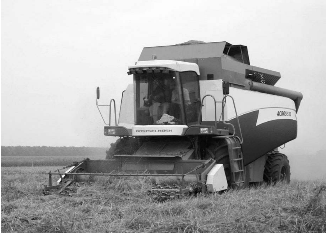
Рисунок 2.7 - Технологический процесс подбора валков платформой-подборщиком
