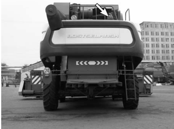
Рисунок 3.100 - Размещение огнетушителя на крыше комбайна
